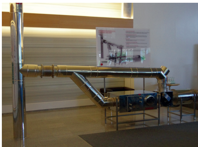
Abbildung unten: Präsentation eines Original Wärmetauschers für ein kleines Blockheizkraftwerk, Schröder Abgastechnologie
